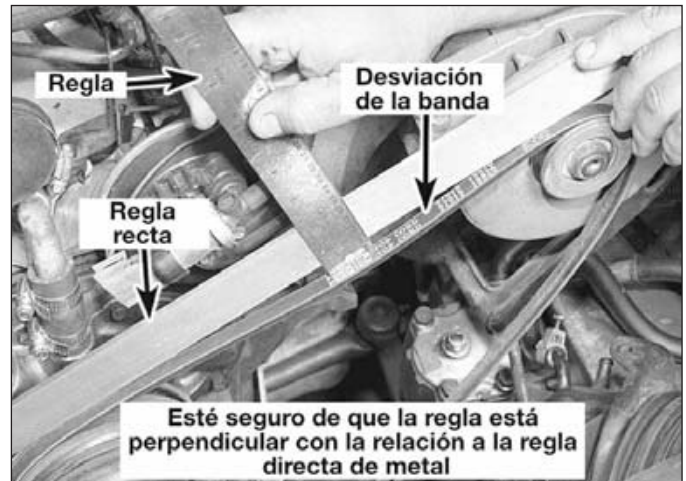
30.4 La tensión de las poleas se pueden chequear con una regla directa de chequear las cabezas y una regla regular
